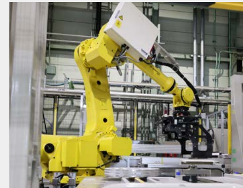
ロボットにより自動化された半導体プロセス部品の超音波探傷試験工程
