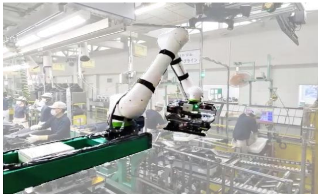
3Dカメラによる位置補正 + 共働ロボットによる コンベアラインへ自動供給
