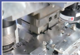
高精度金型によるHDD用サスペンションのプレス加工工程
