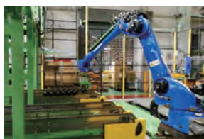
ロボットによる自動搬送や通電式焼熱処理により省人・省エネを実現（懸架ばね事業）
