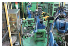
ロボットによる自動搬送や通電式焼熱処理により省人・省エネを実現（懸架ばね事業）
