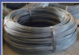
材料メーカーと共同開発したばね用鋼材
