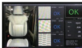
シート外観・形状検査へのAI技術導入による判定作業の自動化と省人化（シート事業）
