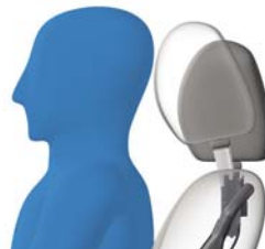
乗員のむち打ち傷害を軽減するアクティブヘッドレスト機構
