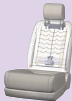
乗員のむち打ち傷害を軽減するアクティブヘッドレスト機構
