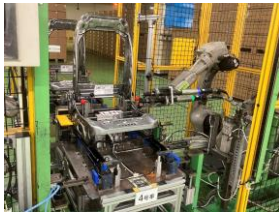
無人搬送車に シートフレームをセットし、 ロボットで締め付け
