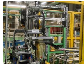
無人搬送車に シートフレームをセットし、 ロボットで締め付け
