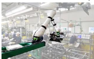
3Dカメラによる位置補正 + 共働ロボットによる コンベアラインへ自動供給
