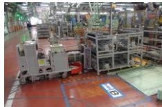
自動搬送装置（AGV/AMR） による運搬の自動化
